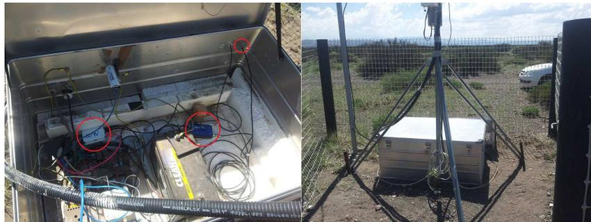
Abbildung 7.1: Elektronik in der Kiste der Wetterstation [67]
