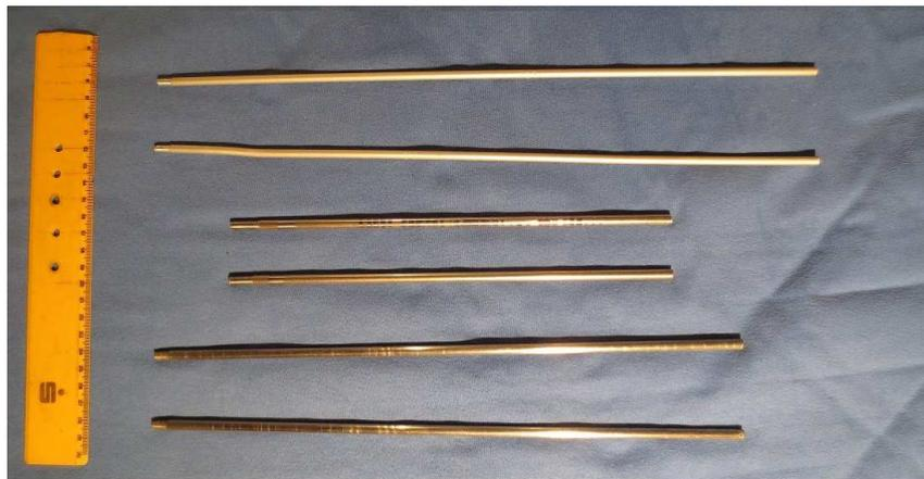
Abbildung 5.13: Längere Zweidrahtsonden für Lecherleitungen
