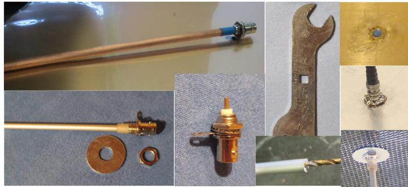
Abbildung 5.10: Metallmonopole, BNC-Stecker, Lochbohrung, Verlötung, Verschraubung
