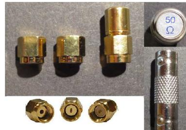
Abbildung 6.1: Kalibrations-Kit für SMA, Load und Open für BNC
