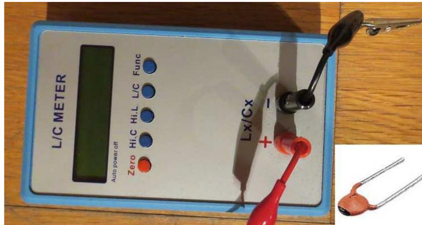
Abbildung 6.8: Zur Bestimmung der Kapazität verwendetes LC-Meter und Keramikscheibenkondensator von <http://www.conrad.de>
