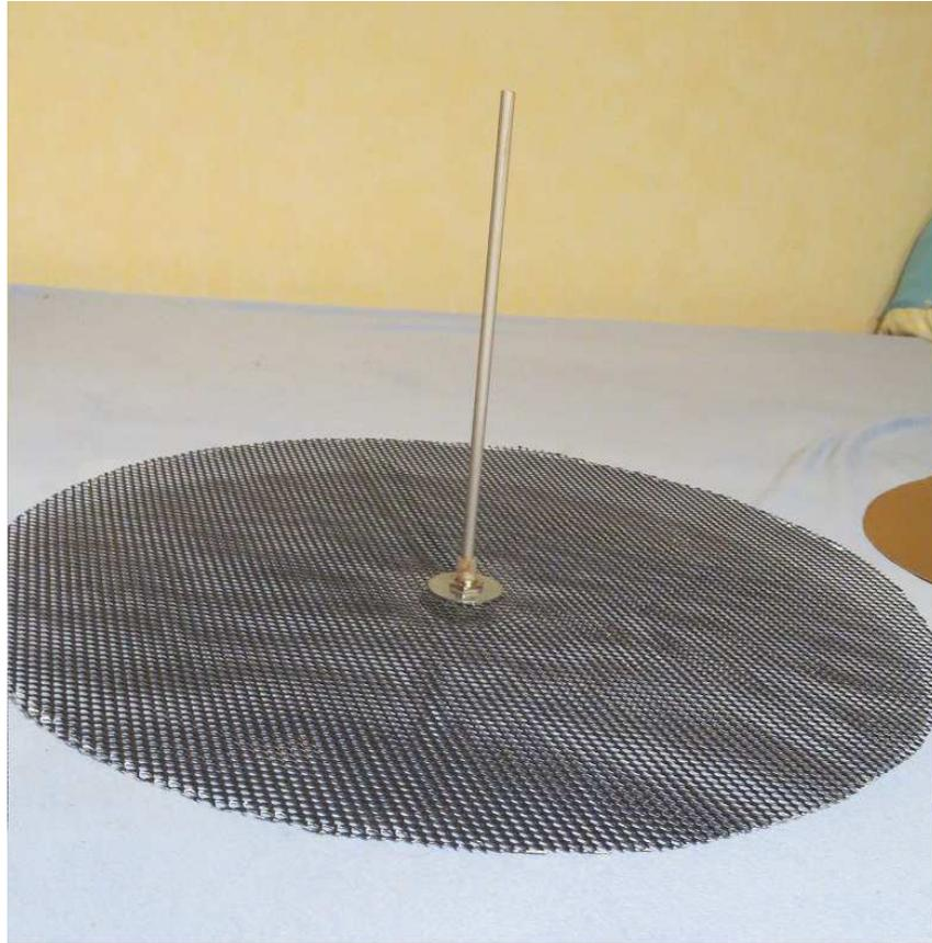
Abbildung 5.8: Alusonde mit Gittergrundplatte.
