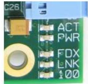
Abbildung A.4: Bedeutung der Status-LEDs des Raspberry Pi Model B
