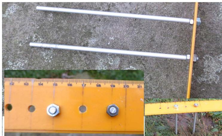
Abbildung 5.11: Elektrisch kurze Zweidrahtsonde
