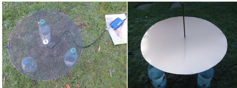
Abbildung 6.10: Messung der Reaktanz in Luft
