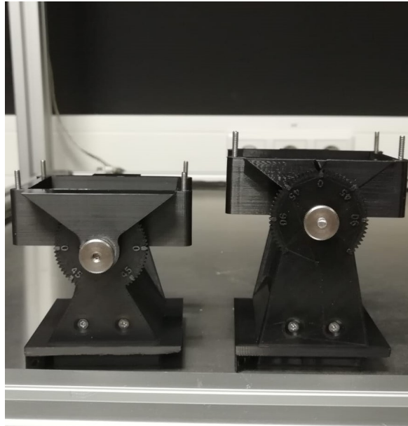
Abbildung 9: Vergleich der zwei rotierbaren Halterungen des Aufbaus. Links kann das Element bis zu einem Winkel von \theta = \pm 50(3) rotiert werden. Dessen Länge beträgt 9,1(5) cm und die Spaltbreite ist 5 mm. Rechts kann das Element bis zu einem Winkel von \theta = \pm 80(3) verschoben werden. Dessen Länge beträgt 11,1(5) cm und die Spaltbreite ist 1 mm.
