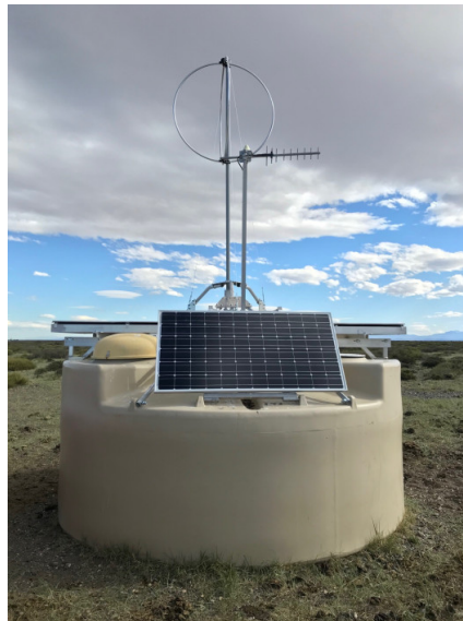
Abbildung 3.2.: WCD mit Solarmodul und einer Radioantenne vom Typ SALLA (Short Aperiodic Loaded Loop Antenna) [8].
