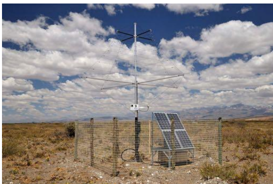
Abbildung 3.6.: Eine Station von AERA mit LPDA [1].
