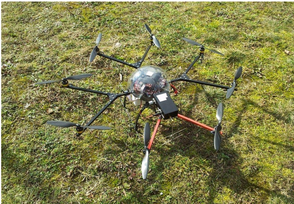
Abbildung 7.1: Oktokopter mit aufmontiertem L-Band Faltdipol.
