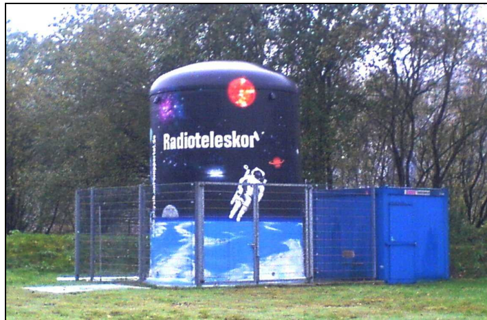
Abbildung 33: Silo mit dem Teleskop (links), Container mit dem Backend und den Rechnern (rechts) [Bellin]
