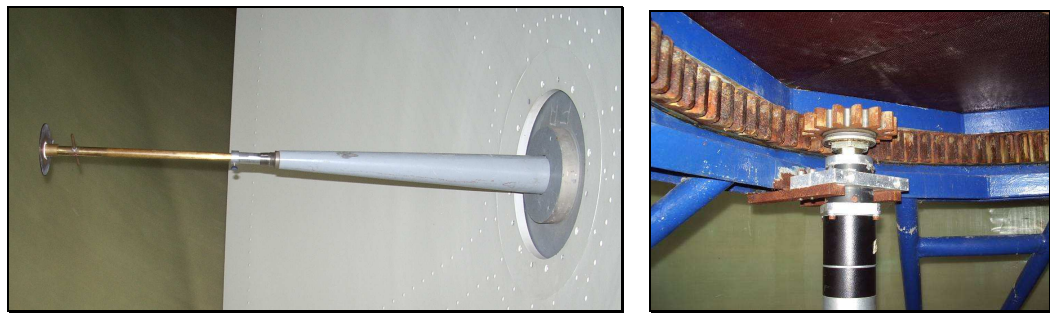
Abbildung 34: links: Dipol-Stange mit Reflektor [Sonntag], rechts: Der Schrittmotor für die Azimut-Ausrichtung [Sonntag]
