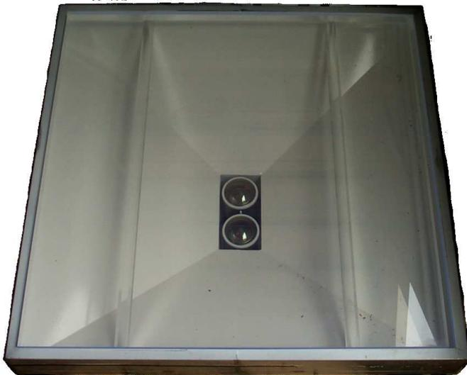
**Abb. F.4:** Blick in einen Detektor. Durch den Szintillator hindurch sind die beiden Photomultiplier für den High Gain- und den Low Gain-Kanal zu sehen.
