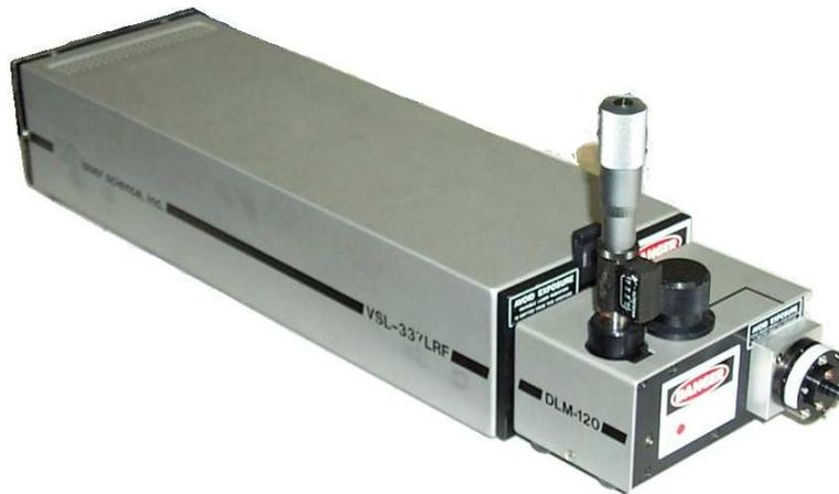
**Abb. F.5:** Der verwendete Laser (Laser Science VSL-337) mit anmontiertem Farbstofflaser-Modul (Laser Science DLM-120) und Fasereinkopplung. Der Laserfarbstoff befindet sich in einer Quarzglasküvette unter der schwarzen zylindrischen Abdeckung. Die Mikrometerschraube dient zur Justierung des Beugungsgitters zur Wellenlängenselektion.
