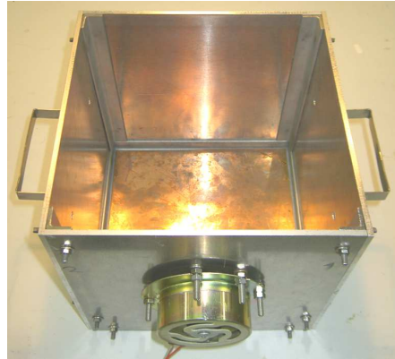
Abbildung 5.10: Die kleine Eisblockform mit dem Bass-Schall-Wandler
