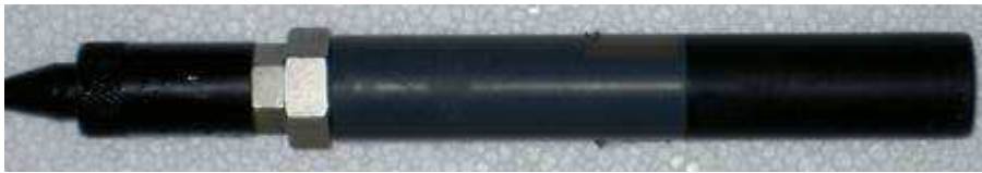
Abbildung 4.23: Das absolut kalibriertes Hydrophon SENSORTECH-SQ03
