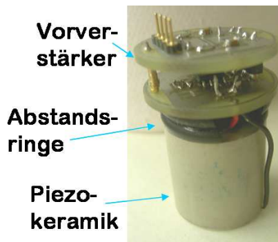
Abbildung 4.12: Die Piezokeramik mit Vorverstärker ohne elektromagnetische Abschirmung (Kupfergitter)
