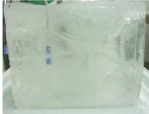
Abbildung 5.12: Ein kleiner Eisblock hergestellt ohne den Bass-Schall-Wandler
