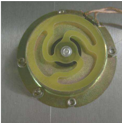
Abbildung 5.9: Der Bass-Schall-Wandler 12 cm · 4 cm (Durchmesser · Höhe) an der kleinen Eisblockform
