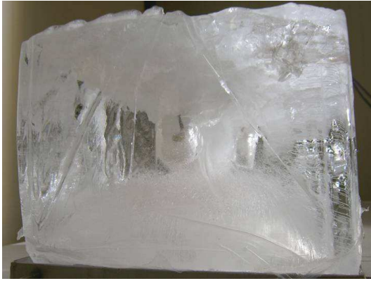
Abbildung 5.11: Ein kleiner Eisblock hergestellt mit dem Bass-Schall-Wandler
