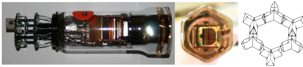
Abbildung 3.6: Links und Mitte: Photonis PMT mit angelöteter Base (Fotos von Sven Querchfeld). Rechts: Zeichnung eines Reflektor-Rings (aus [27]).
