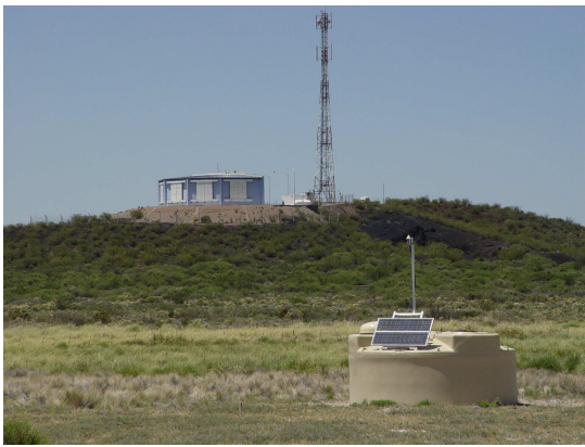
Abbildung 3.1: Fluoreszenz-Detektor Los Leones im Hintergrund mit dem nächsten Oberflächentank im Vordergrund (aus [25]).
