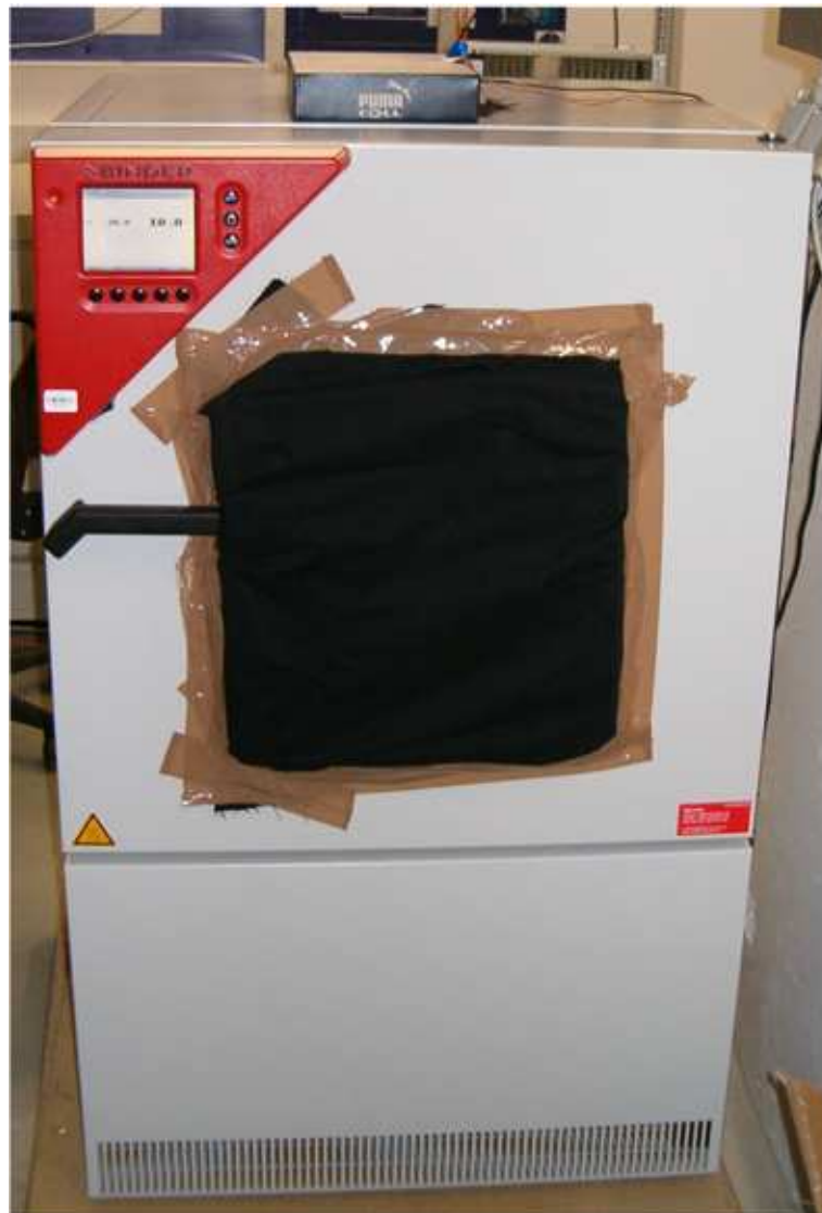
Abbildung D.1: Die Kälte-/Wärmetestkammer der Firma BINDER GmbH. Man erkennt das abgedeckte Sichtfenster, das Bedienpanel sowie die Kabeldurchführung an der Oberseite, welche mit einem zusätzlichen Karton gegen Lichteinfall geschützt wurde.
