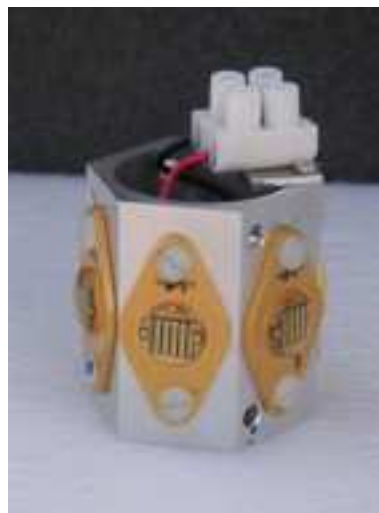
Abbildung 7.19: Der von Becker im Rahmen seiner Diplomarbeit verwendete LED-Ring aus sechs Arrays (nach [13]).
