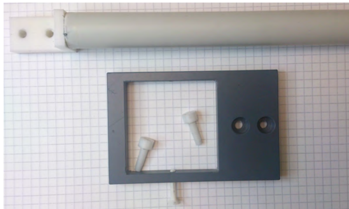
Abbildung 30: Links der Versuchsaufbau in der 90°-Stellung, Winkel können durch eine Drehung am Halterungsarm eingestellt werden. Rechts die Kerben in 45° Abständen im Halterungsfuß zur Winkeleinstellung zu sehen.
