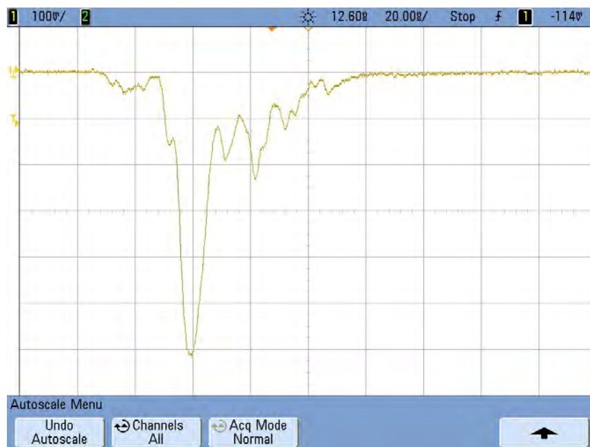
Figure A.1: Impuls aus Tonne 0 mit Doppelspitze, der bei passender Schwellspannung potentiell als 2 Peaks gemessen werden könnte. Eine Einheit in x-Richtung (gepunktete Linien) entspricht dabei 20 ns, und eine Einheit in y-Richtung entspricht 100mV.
