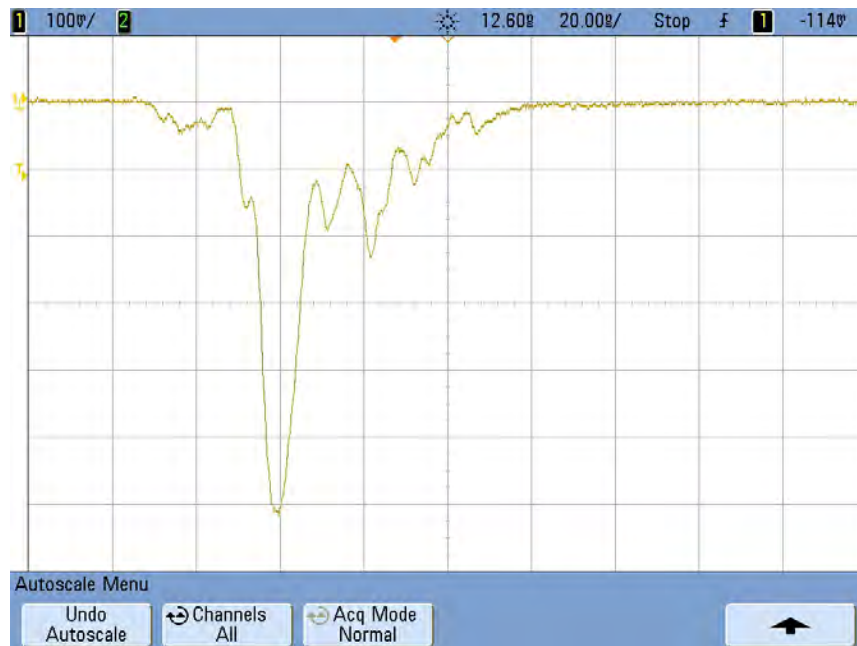
Figure 4.2: Impuls aus Tonne 0 mit Doppelspitze, der bei passender Schwellspannung potentiell als 2 Peaks gemessen werden könnte. Eine Einheit in x-Richtung (gepunktete Linien) entspricht dabei 20 ns, und eine Einheit in y-Richtung entspricht 100mV.
