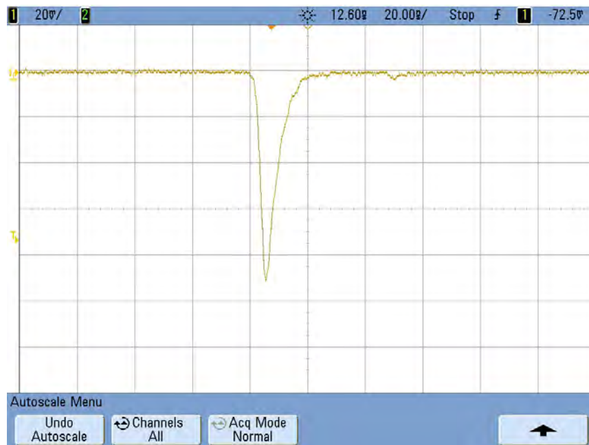
Figure A.3: Impuls aus Tonne 3. Eine Einheit in x-Richtung (gepunktete Linien) entspricht dabei 20 ns, und eine Einheit in y-Richtung entspricht 20mV.
