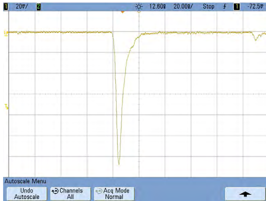
Figure A.2: Impuls aus Tonne 1. Eine Einheit in x-Richtung (gepunktete Linien) entspricht dabei 20 ns, und eine Einheit in y-Richtung entspricht 20mV.
